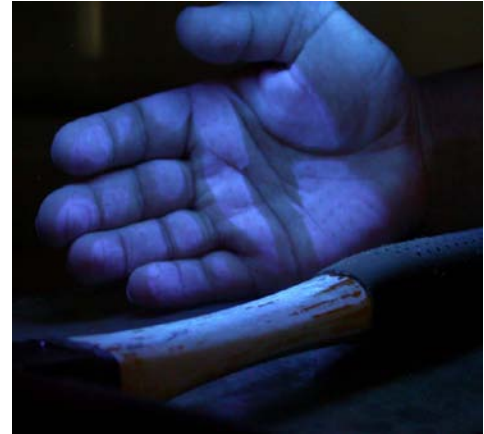
Abbildung 5: Hand (mit Feuchtigkeitscreme leicht eingecremt) nach einmaligem Anfassen eines gummiummantelten Hammerstiels. Unter UV-Licht fluoreszieren die Stellen, auf die durch den Kontakt mit dem Gummi PAK übertragen wurden. Löcher in der Ummantelung zeichnen sich ab.
